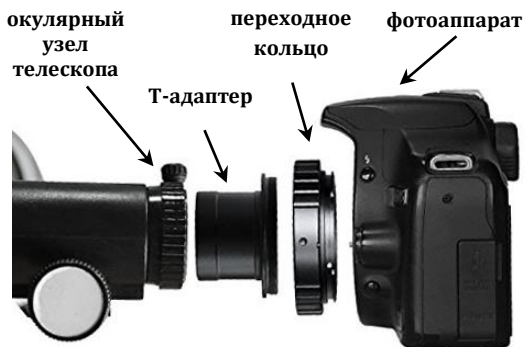
Рис. 1.3. Схема соединения фотоаппарата с окулярным узлом телескопа. источник: http://www.100market.net/
