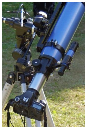
Рис. 1.2. Соединение фотоаппарата с телескопом через Т-адаптер.
