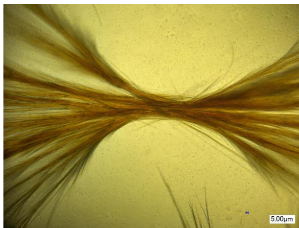
Электронно-микроскопическое изображение нитевидных структур соединения ( L II )
