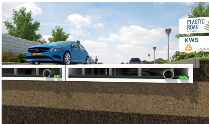
Рис. 1. Схема устройства «пластиковой» дороги [3]
