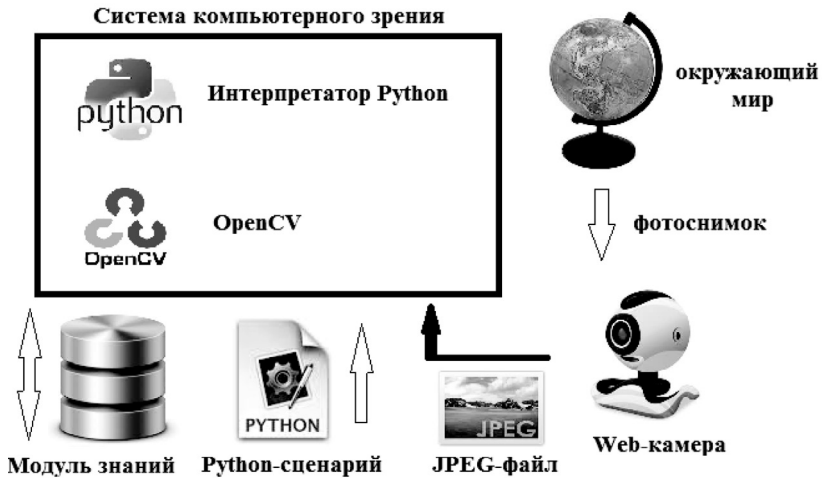
Рисунок 1. Структура системы компьютерного зрения
