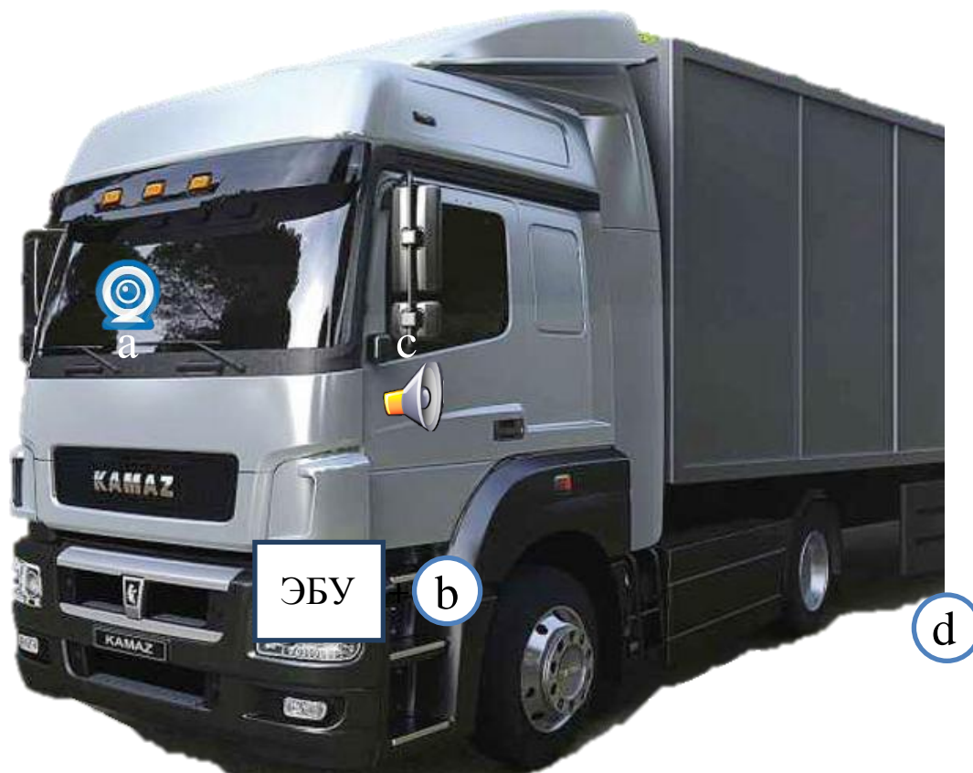
Рис. 1. Основные элементы системы распознавания препятствий и предупреждения водителя
