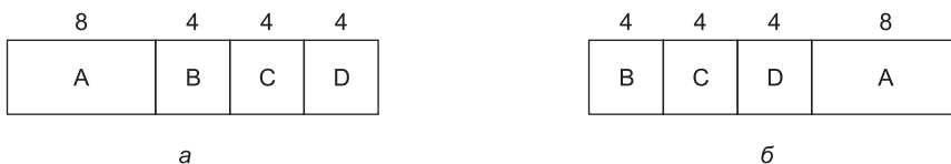
Рис. 2.21. Пример планирования, когда первым выполняется самое короткое задание: a — запуск четырех заданий в исходном порядке; б — запуск этих заданий в порядке, когда самое короткое из них выполняется первым
