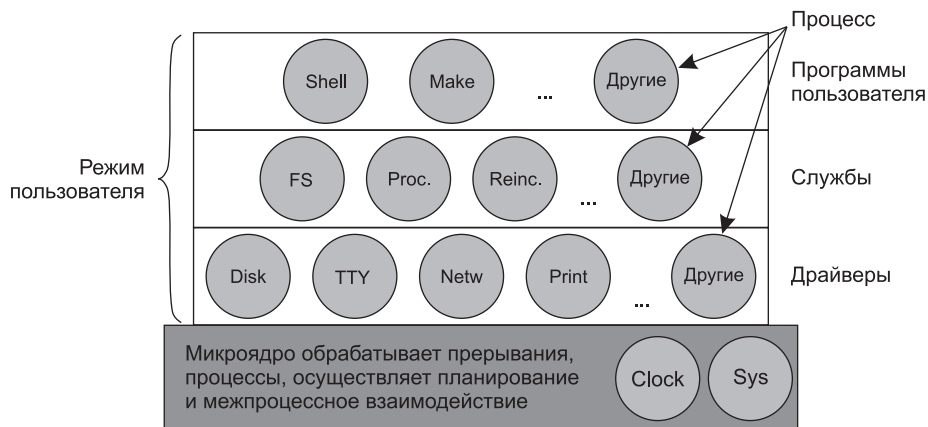
Рис. 1.22. Упрощенная структура системы MINIX 3
