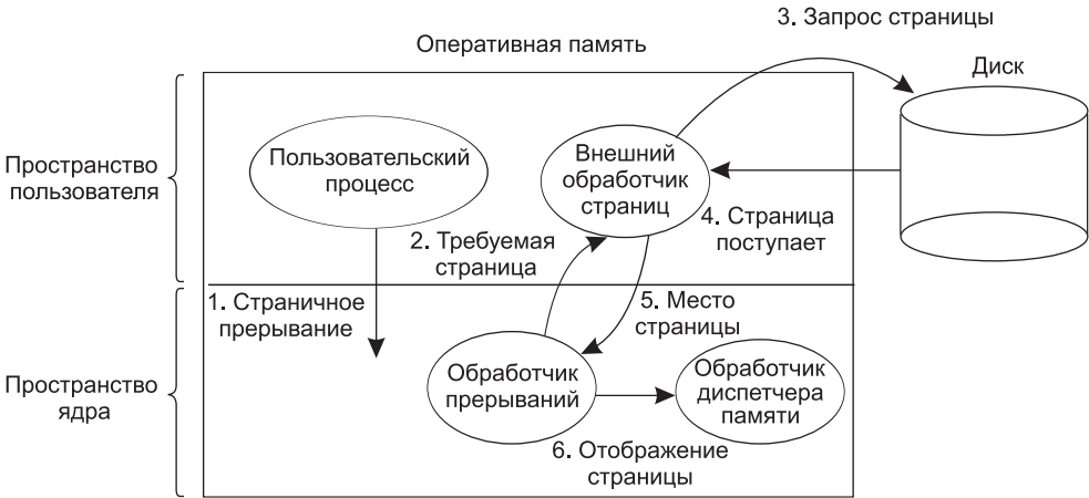
Рис. 3.27. Обработка ошибки отсутствия страницы с использованием внешней системы страничной организации памяти
