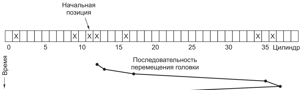
Рис. 5.21. Алгоритм лифта для планирования обслуживания дисковых запросов
