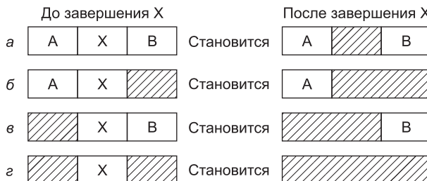
Рис. 3.7. Четыре комбинации соседей для завершающегося процесса X
