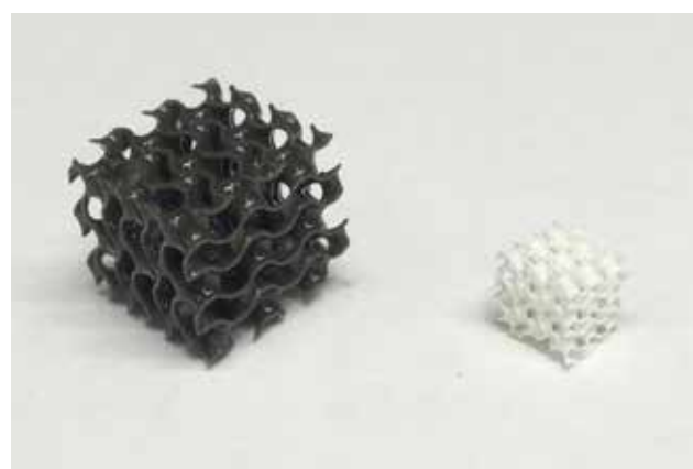
Рис. 3. Макропористый материал до обжига, представляющий собой композит «полимер/окрашенный порошок фосфата кальция» (слева) и керамический материал после обжига (справа). Длина ребра образца до обжига – 11,6 мм, после обжига – 6,1 мм.
