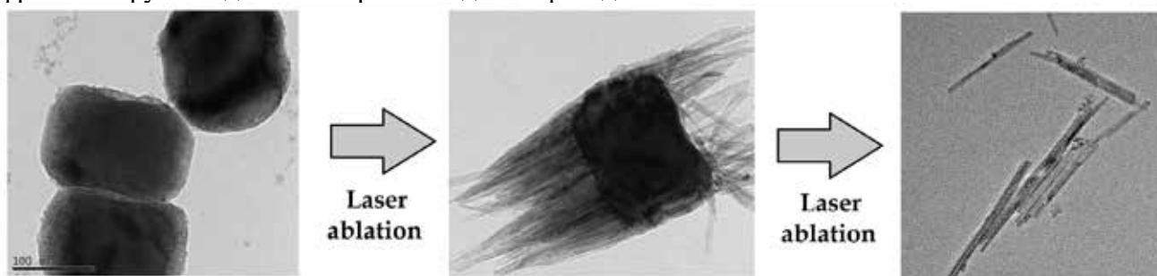
Рис. 1. Фрагментация наночастиц \text{NaYF}_4: \text{Yb}, \text{Tm} в процессе лазерной абляции пикосекундными импульсами.
