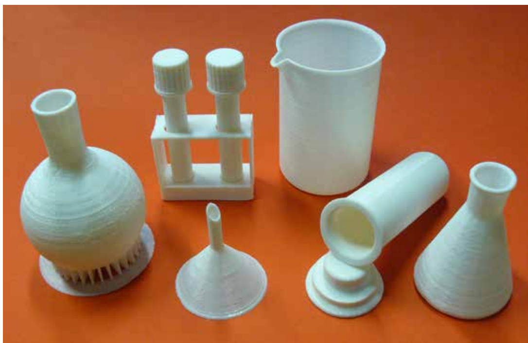
Рис. 1. Образцы типового лабораторного оборудования, созданного методом FDM-печати, и используемого в повседневной лабораторной практике.
