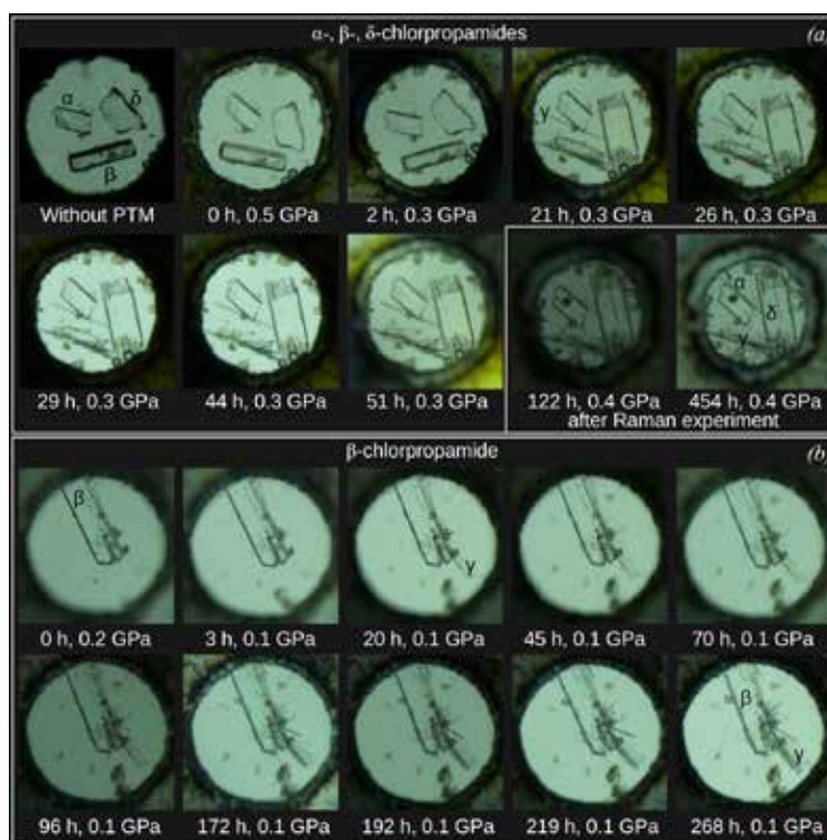
Рис. 1. Перекристаллизация хлорпропамида в смеси пентана с изопентаном (1:1) под давлением
