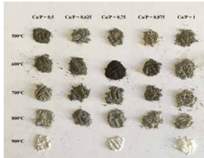
Рис. 1. Внешний вид порошков фосфатов кальция с соотношением 0,5 \leq \text{Ca/P} \leq 1 , синтезированных из ацетата кальция и гидрофосфата аммония, после термической обработки в интервале температур от 500 до 900°C.
