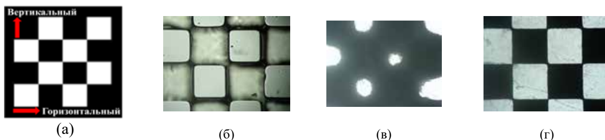
Рис. 2. Примеры двумерных образцов, полученных полимеризацией при облучении через маску (а) ненаполненной смеси мономеров (б); суспензии, содержащей смесь мономеров и 40 об.% белого порошка фосфатов кальция (900°С) (в); суспензии, содержащей смесь мономеров и 40 об.% окрашенного порошка фосфатов кальция (700°С) (г).
