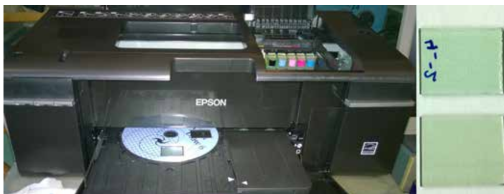
Рис. 3. Струйная печать электроактивного слоя для солнечного элемента и получаемые слои композитов ПАНИ.
