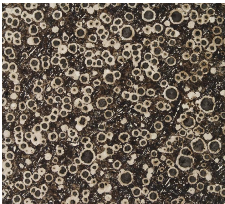
Рис. 7. Металлическая основа образца, вырезанного в широком сечении отливки после нормализации
