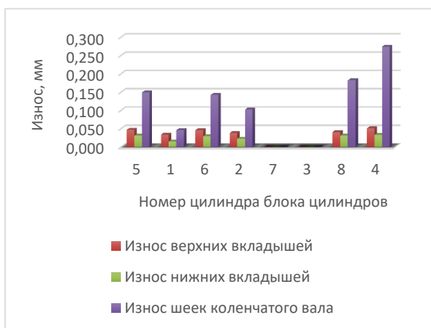
Рис. 1. Износ вкладышей шатунных подшипников двигателя с коленчатым валом №1
