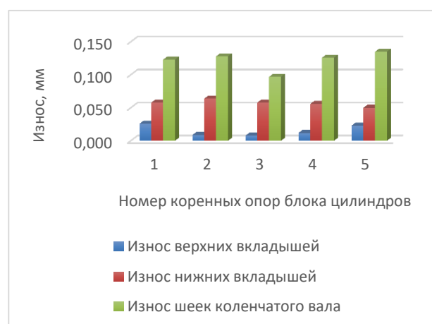
Рис. 4. Износ вкладышей коренных подшипников двигателя с коленчатым валом №1
