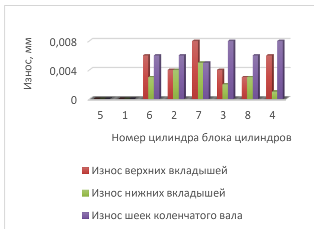
Рис. 3. Износ вкладышей шатунных подшипников двигателя с коленчатым валом №3
