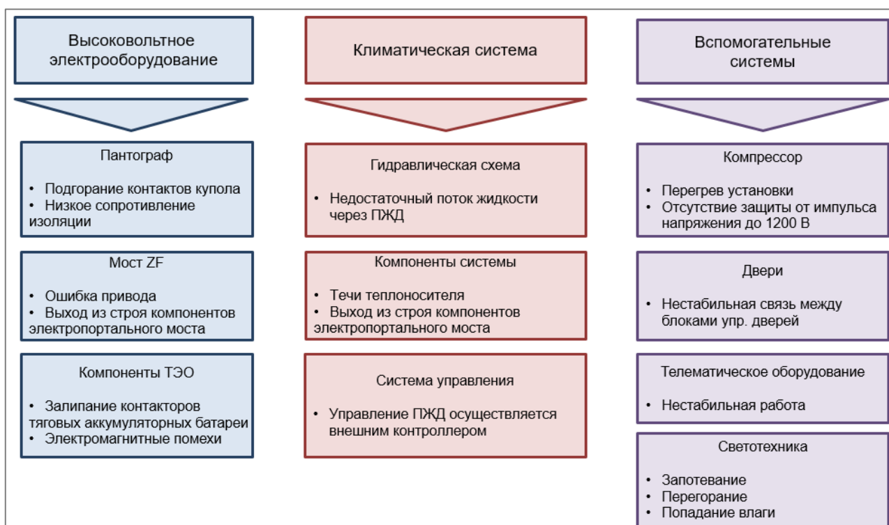
Рис. 2. Выявленные недостатки при эксплуатации электробуса
