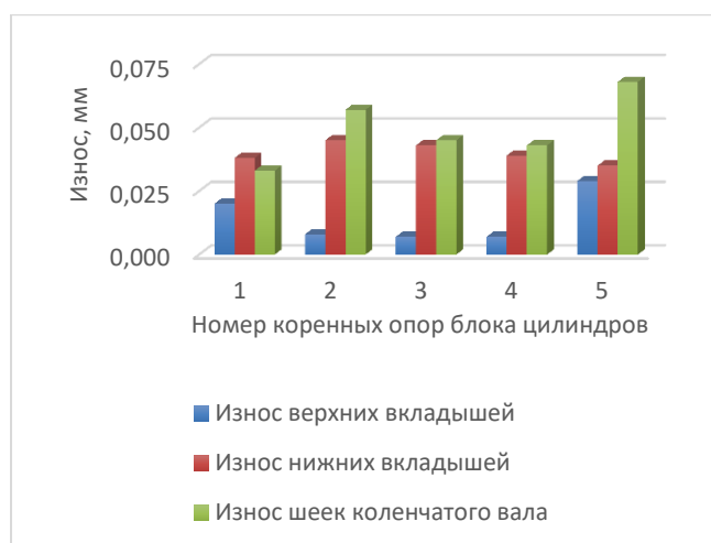
Рис. 5. Износ вкладышей коренных подшипников двигателя с коленчатым валом №2
