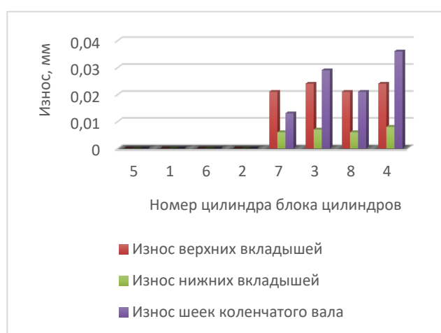
Рис. 2. Износ вкладышей шатунных подшипников двигателя с коленчатым валом №2
