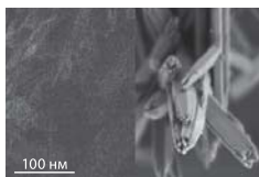
500 В, 7 пА Новый InLensSE детектор справа Детектор InLens в 20х чувствительнее при низких кВ
