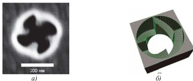
Рис. 1. Единичная 3D хиральная наноструктура диаметром 230 нм в поликристаллической золотой пленке толщиной 200 нм: а) Изображение РЭМ; б) 3D модель шаблона травления
