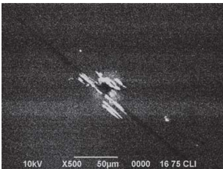
Рис. 2. КЛ изображение 4H-SiC с отпечатком индентора, полученное на длине волны 422 нм.
