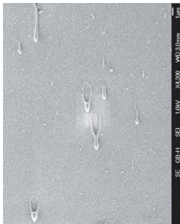
Рис. 2. Микроснимок поверхности образца-свидетеля из полированного кремния.
