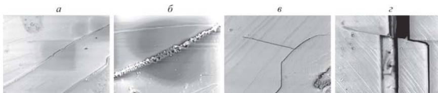
Рис. 1. РЭМ-изображение поверхности кальцита после воздействия МЭМИ в течение 30 с (а) – (б) и 50 с (в, з). Увеличение: 400 (а), 1600 (б), 370 (в), 550 (з)
