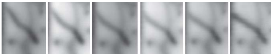
Рис. 1. Последовательные изображения в режиме НТ фрагмента латерально-зарощенной пленки GaN. Видно, что происходит изменение формы темного дефекта.
