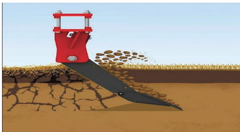
Рис. 1. Рабочий орган глубокорыхлителя разрушает плужную подошву
