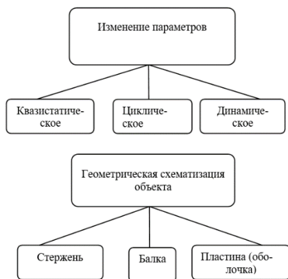
Рис. 1. Классификация рассматриваемых расчётных моделей конструктивных элементов с отслоениями
