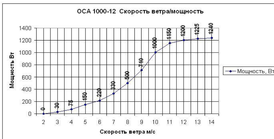
Рис. 3. Изменение мощности в зависимости от скорости ветра для ветрогенератора OCA 1000-12
