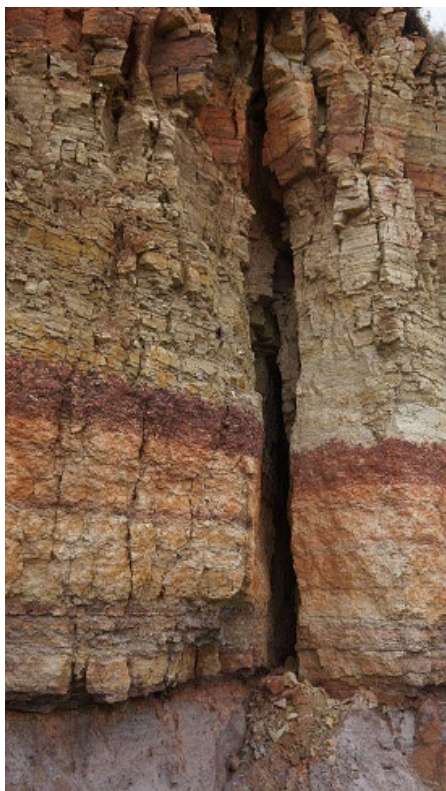
Рис. 6. Характер трещиноватости известняков бурегской свиты (фото авторов)
