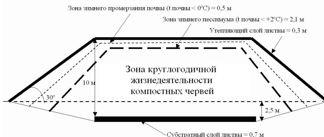
Рис. 3. Схема почвенного бурта, предназначенного для вермитехнологической рекультивации почвенного массива
