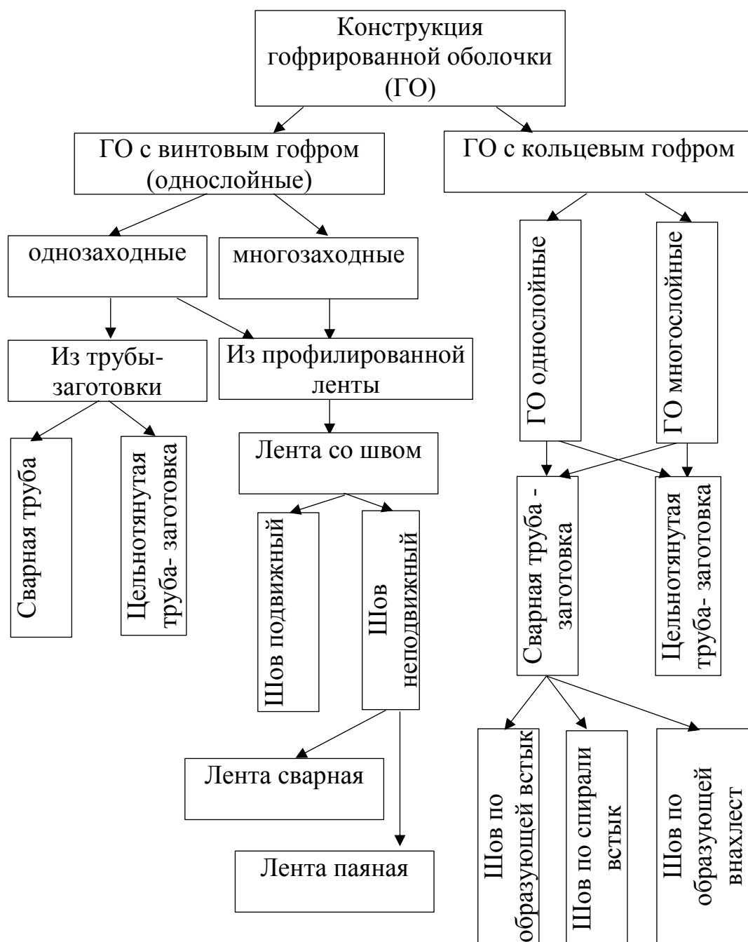
Рис. 1.11 Классификация гофрированных оболочек ГМТ
