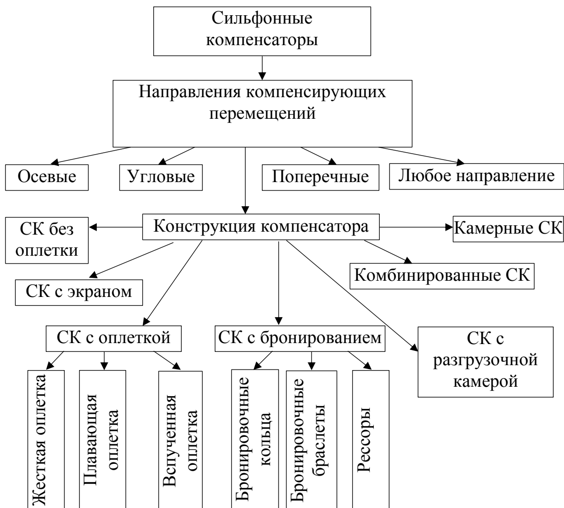
Рис. 1.12 Классификация сильфонных компенсаторов
