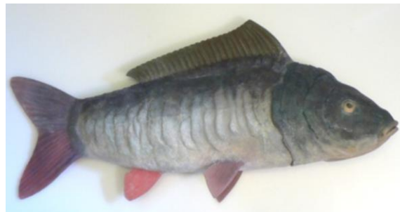
Рис. 2. Силиконовое покрытие CyberFish ver. 5 [4]
