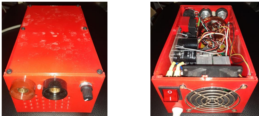
Рис. 5. Разработанный источник в корпусе – слева; справа – со снятой верхней крышкой
