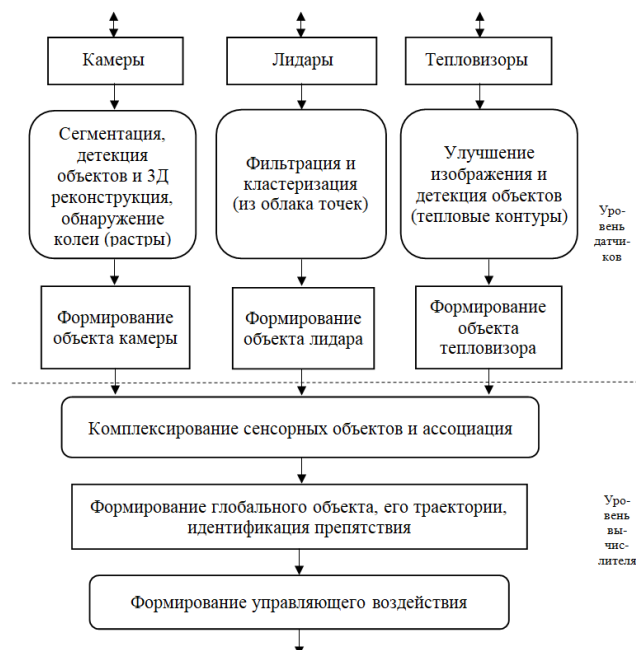
Рис. 2. Блок-схема работы бортовой СТЗ для обнаружения препятствий
