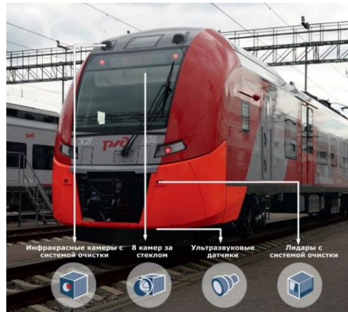
Рис. 1. Расположение оборудования СТЗ на электропоезде «Ласточка» (модель ЭС2Г-136)
