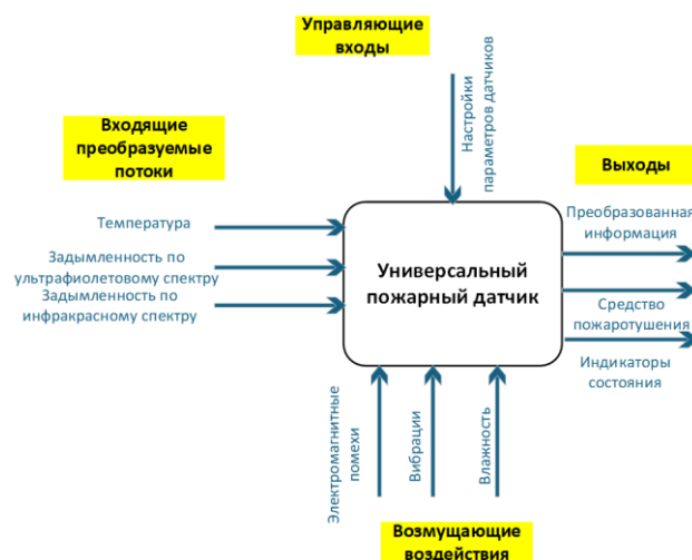
Рис. 1. Параметрическая модель универсального пожарного датчика
