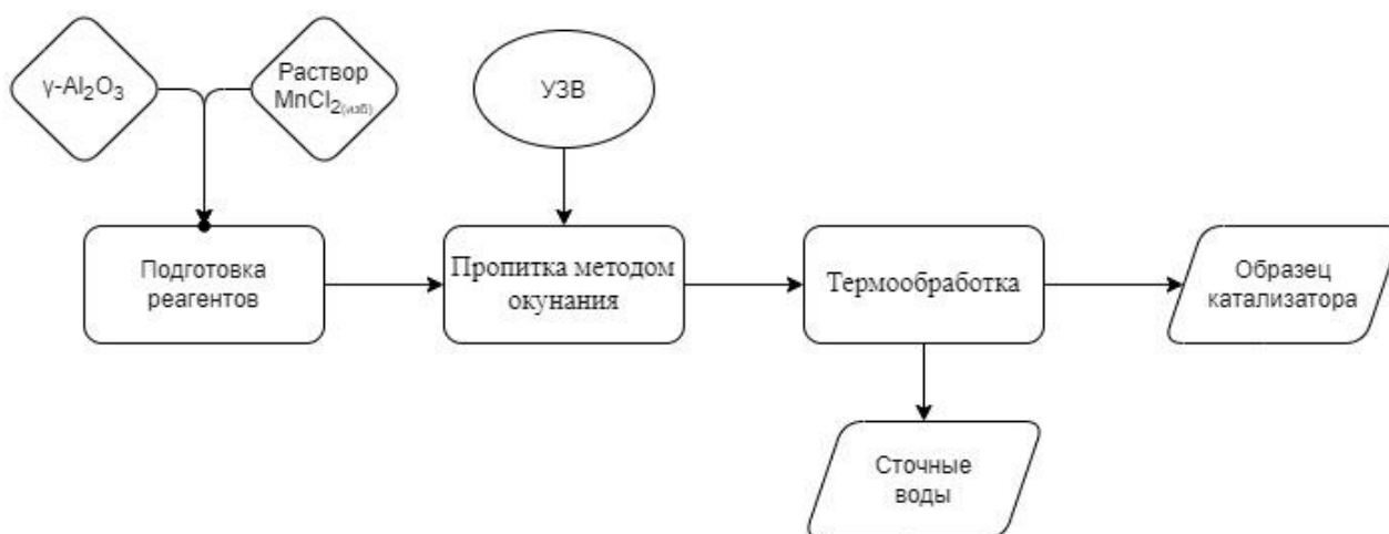
Рис. 1. Схема приготовления катализатора методом окупания
