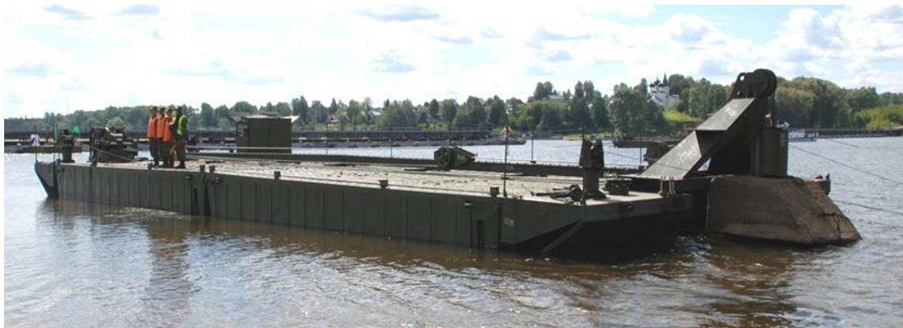
Рис. 8. Якорница на средних понтонах без рельса марки П (МЛЖ-ВФ-ВТ), с оборудованием для установки якорей-присосов
