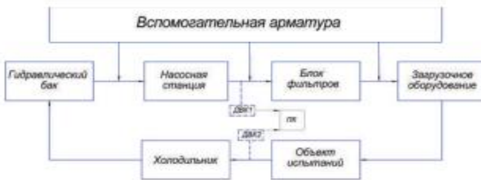
Рис 1. Обобщенная структурная схема типового стенда для испытания гидравлических агрегатов с ДВК
