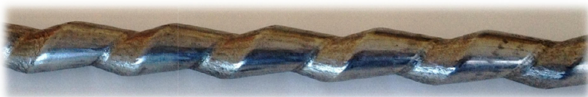
Рис. 3. Фрагмент теплообменного элемента, полученного методом ротационного обжатия
