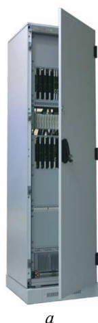
Рис. 2. Компоненты учебного стенда: a – учрежденческо-производственная автоматическая телефонная станция «МиниКом DX-500С»; б – рабочее место оператора ручного междугородного коммутатора
