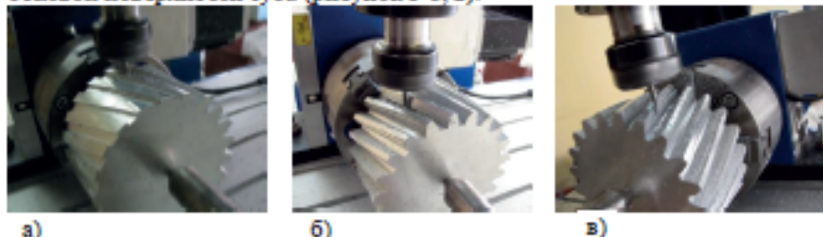
а) Рисунок 3. Обработка зубчатого венца цилиндрического колеса. а) получистовое фрезерование, б) фрезерование левой боковой поверхности впадины, в) фрезерование правой боковой поверхности впадины.
