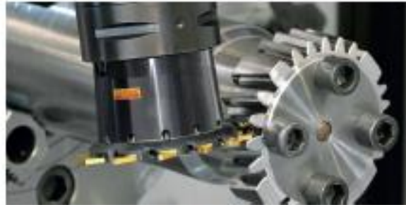
Рисунок 2. Обработка зубьев цилиндрического зубчатого колеса специальными фрезами Sandvik CoroMill 161 и CoroMill 162 [2].
