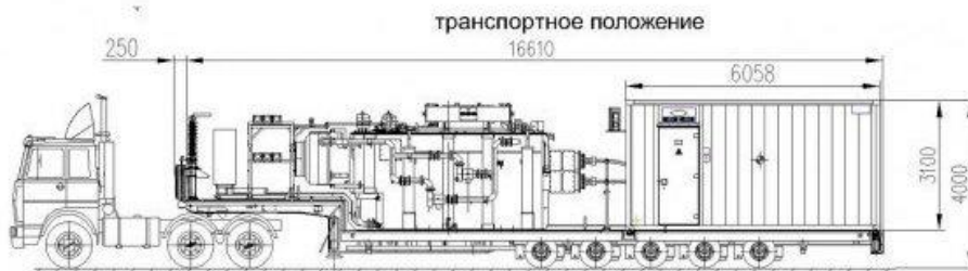
Рисунок 4 – ММПС 35/10(6) кВ мощностью 25 МВА, предлагаемая компанией «СПЕЦЭНЕРГО»
