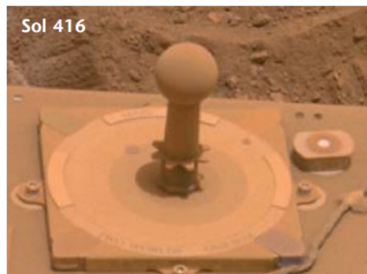
Осаждение пыли на калибровочном элементе марсохода СПИРИТ за 400 дней (2004-2006)
