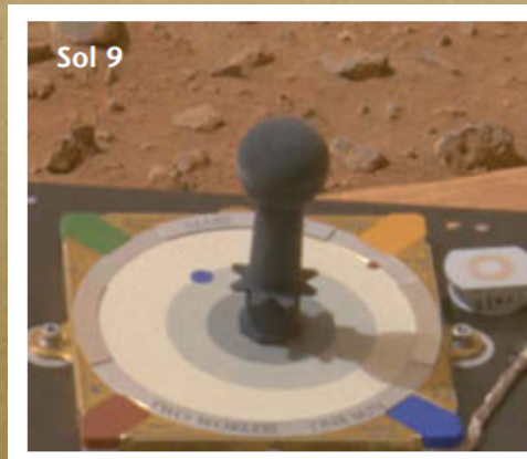
Осаждение пыли на калибровочном элементе марсохода СПИРИТ за 400 дней (2004-2006)
