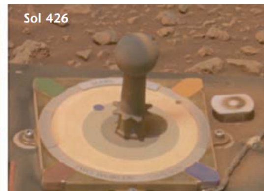
Осаждение пыли на калибровочном элементе марсохода СПИРИТ за 400 дней (2004-2006)
