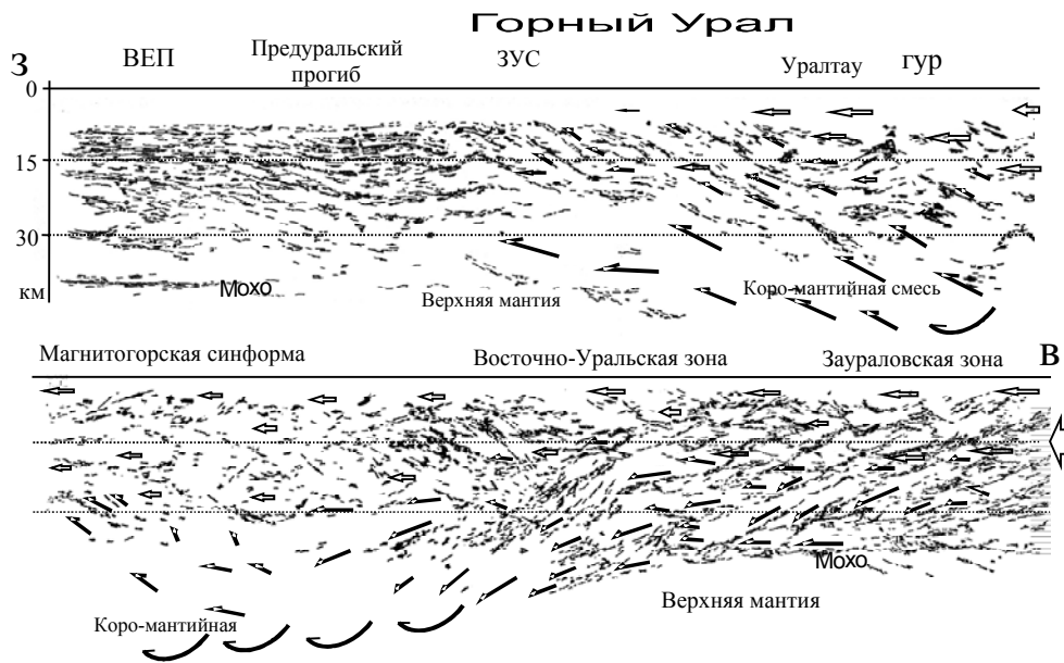
Рис. 4. Сейсмические неоднородности в земной коре по профилю УРСЕЙС-95 и их интерпретация применительно к горообразованию
