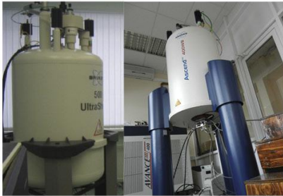
NMR-spectrometer Bruker Avance 500
