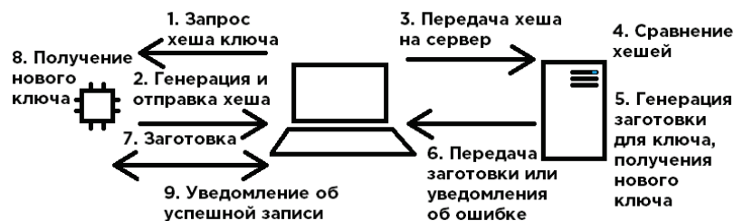
Рис. 8. Алгоритм подтверждения и обновления ключа токена во время выполнения действия
