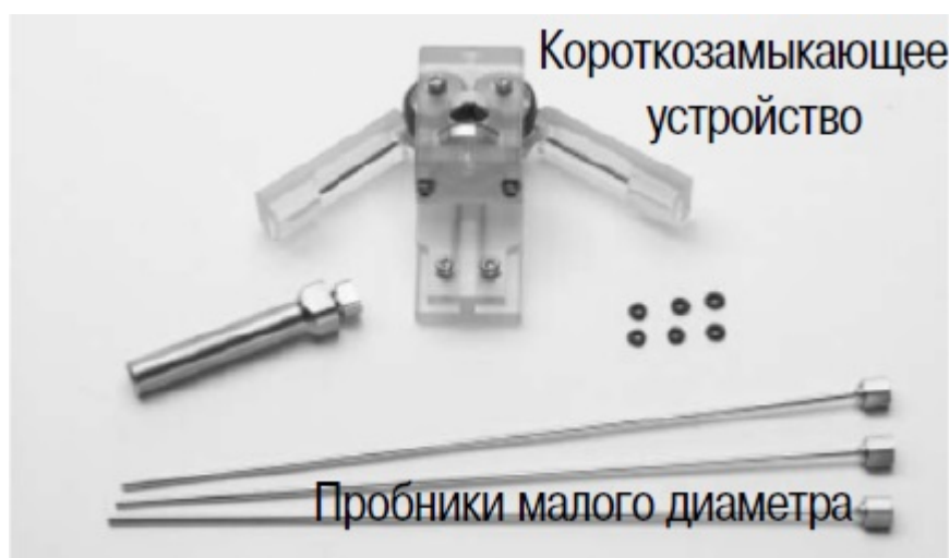
Рисунок 15. Короткозамыкающее устройство, применяемое для калибровки
