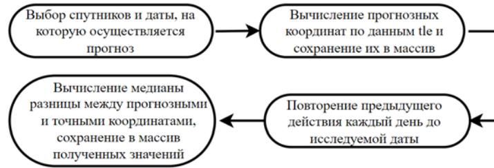
Рис. 3. Блок-схема прогнозирования положения спутников на орбите
