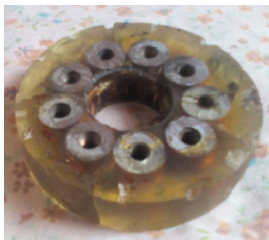
Рисунок 3. Статор со сквозными отверстиями охлаждения
