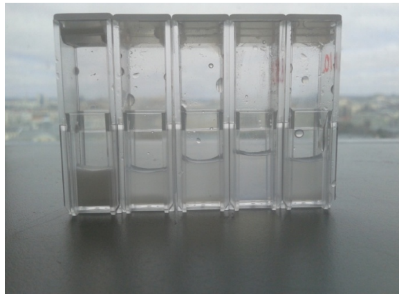
Рисунок 2. Кюветы с порошком диоксида кремния \text{SiO}_2 , размешанные в растворе глицерина и воды
