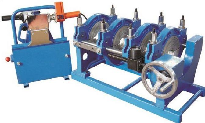
Используемые для сварки полиэтиленовых труб, а также для сварки разнообразных фасонных изделий. При стыковой сварке труб прогрев труб имеет две ступени, после которых термоагревательный элемент максимально быстро убирается и трубы, находящиеся под нагнетаемым гидроагрегатом, плотно прижимаются друг к другу торцами, пока сварной шов не остынет.
