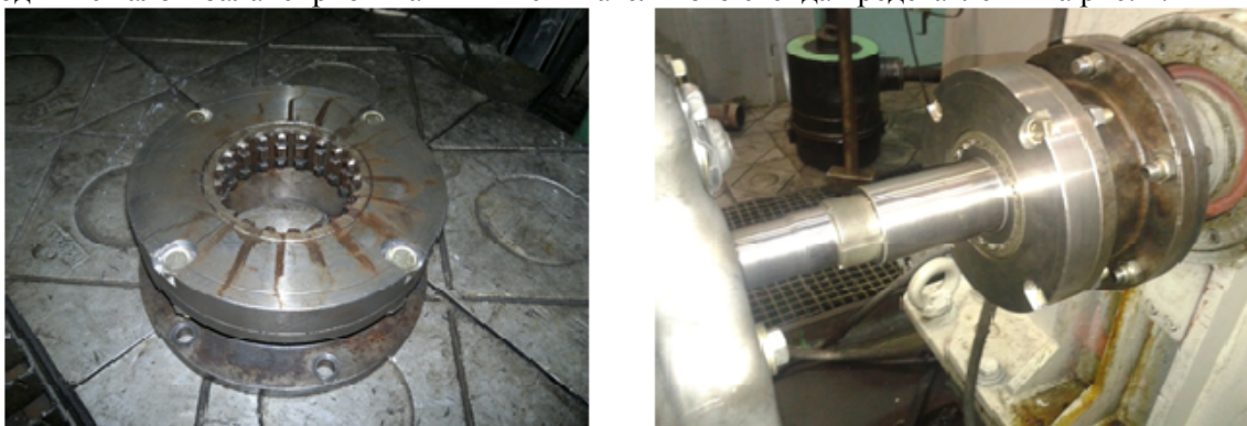
Рисунок 2. – Переходник для соединения первичного вала коробки передач с валом балансирующей машины испытательного стенда.
