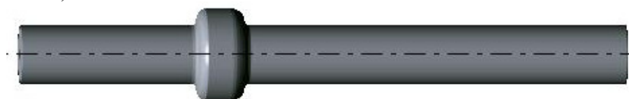
Рисунок 5. – Конечный результат деформирования поковки «Вал барабана лебедки».
