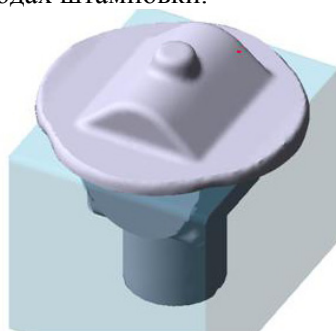
Рисунок 7. – Конечный результат деформирования поковки «Полуось».
