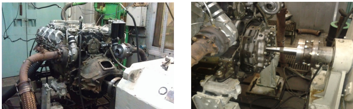
Рисунок 1. – Двигатель в сборе со сцеплением, установленный на испытательный стенд.
