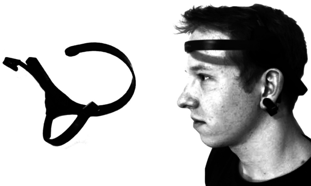
Рис. 1. Устройство NeuroSky MindWave: а) внешний вид устройства; б) пример крепления устройства на голове испытуемого
