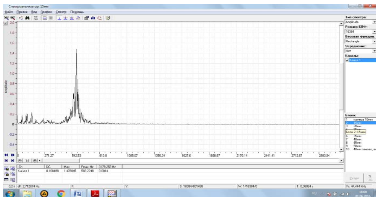
Рис.А.2. АЧХ в ходе озвучивания камеры длиной 15 мм белым шумом
