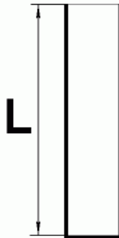
Рис.1.2. Схема четвертьволнового резонатора
