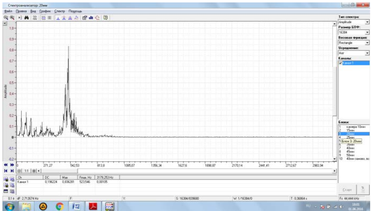
Рис.А.3. АЧХ в ходе озвучивания камеры длиной 20 мм белым шумом
