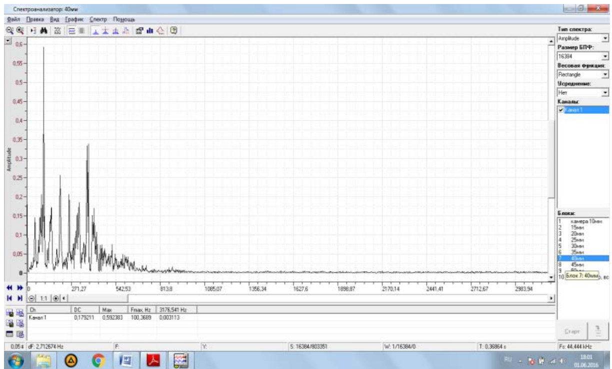
Рис.А.7. АЧХ в ходе озвучивания камеры длиной 40 мм белым шумом
