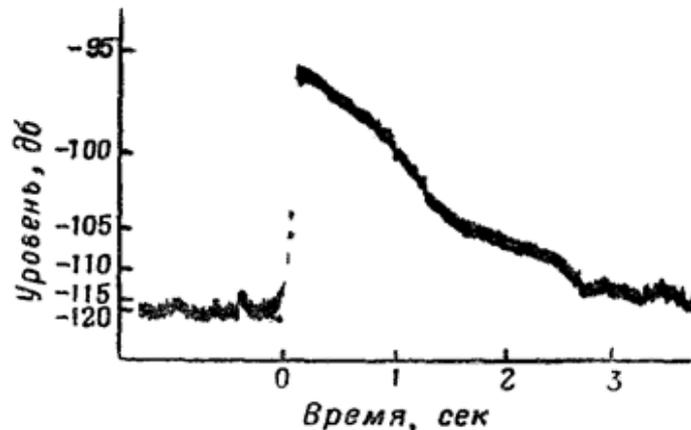
*Рис.2.4 – Сигнал, зеркально отраженный от неуплотненного следа*
