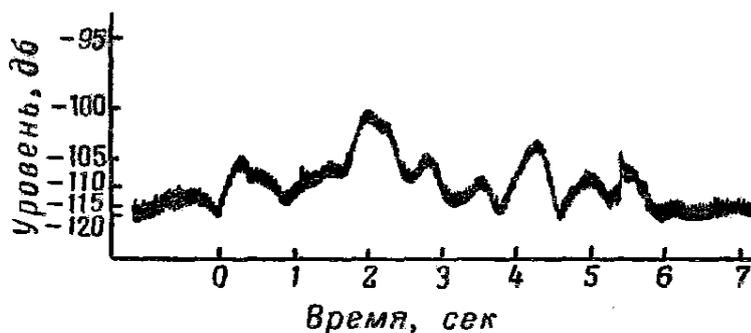
**Рис.2.6** – Разновидность сигнала, отраженного от переуплотненного следа, с колебаниями уровня, обусловленными высотным ветром (незеркальное отражение)
