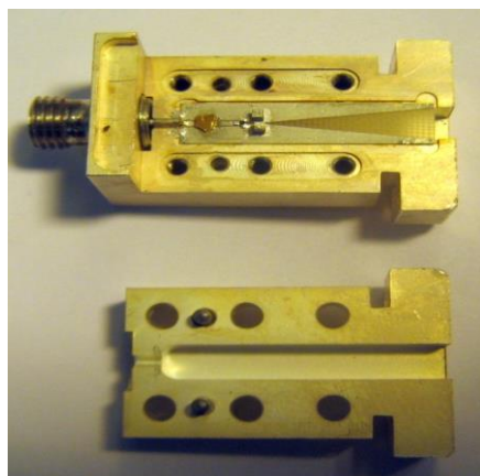
Рис. 3. Внешний вид удвоителя частоты для диапазона (26÷40) ГГц
