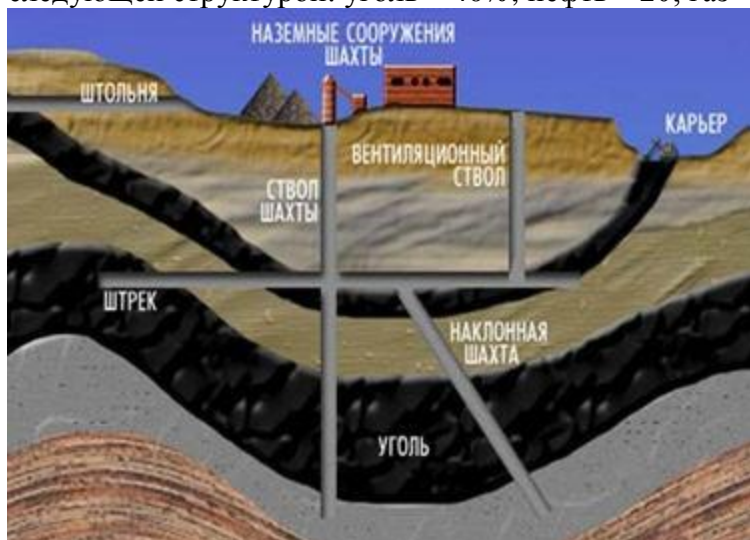
Рис. 1. Добыча угля подземным способом, схема разработки месторождения
