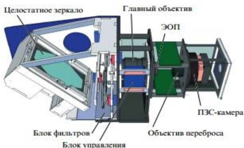
Рис. 2.1.1. Отдельный канал системы регистрации. Несколько (шесть или девять) таких каналов составляют базовый блок [8].
