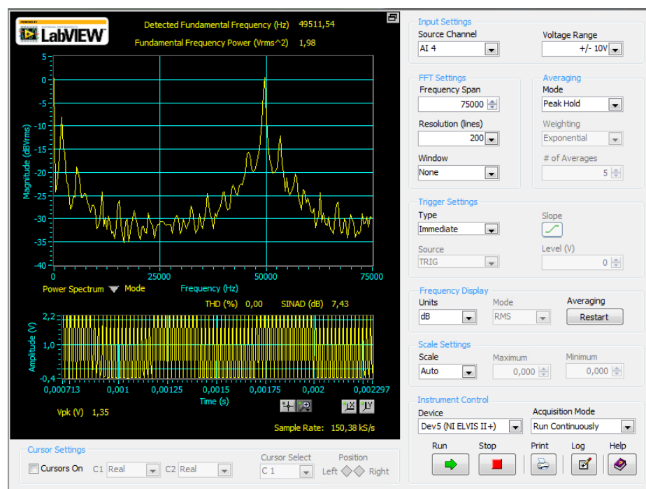
Рисунок 44 – Спектр прямоугольного сигнала
