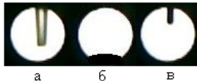
Рисунок 1.2 – Изображение видеокамерой полости графитовой печи а – с наконечником дозатора, б – с каплей пробы на нижней стенке, в – с зондом внутри
