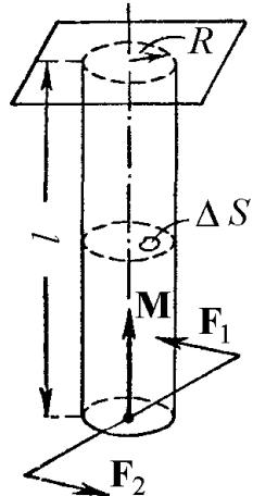
где  $l$  – длина стержня,  $R$  – радиус его сечения,  $G$  – модуль сдвига,  $M$  – вращательный момент (момент сил).
