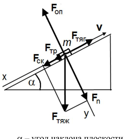
$\alpha$  – угол наклона плоскости
