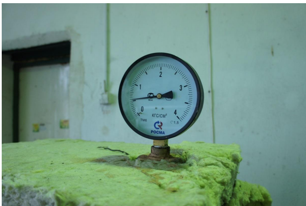
Рисунок 6.4- Давление внутри стенда через 14 часов нагрева
