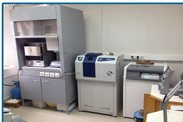
Литейный участок: Форвакуумная литейная установка Ugin Ducatron Центробежная литейная установка Ugin Inducast
