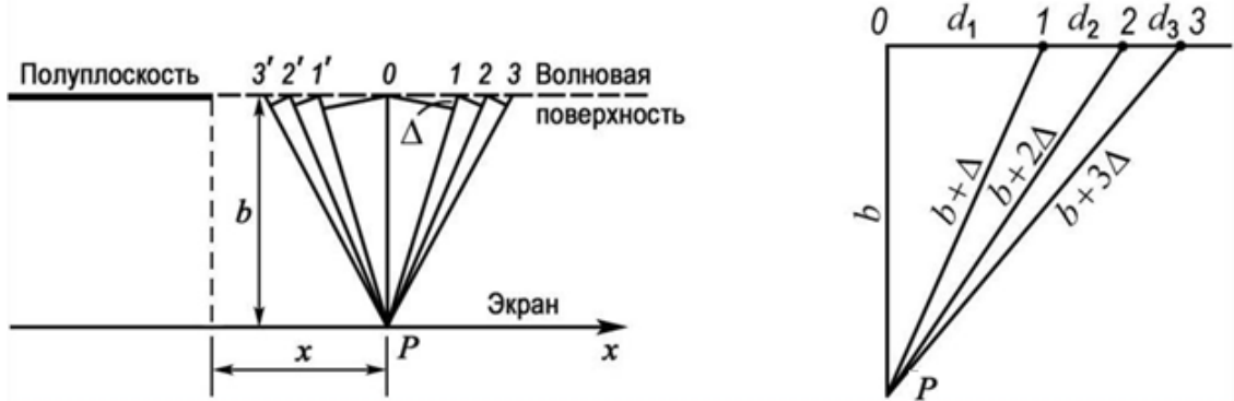
Рис. 4. Построение зон Шустера для случая нормального падения плоской световой волна на полуплоскость.
