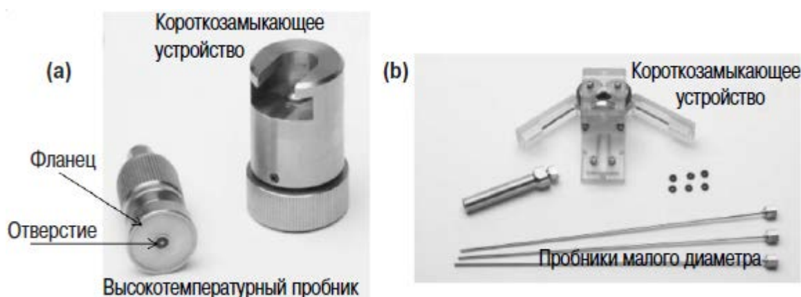
Рисунок 8. Две конфигурации диэлектрических пробников.
