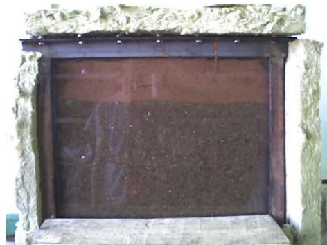
Рисунок 5.3 - Начало образования паровой камеры через 9,5 часов нагрева
