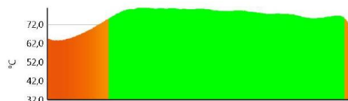
Рисунок 5.8 - Вскипание воды в стэнде после сброса давления через 13 часов нагрева
