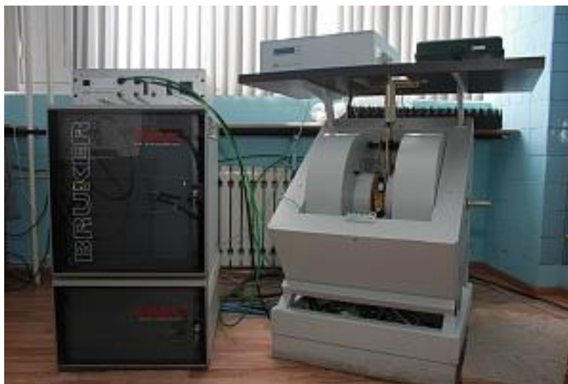
Рисунок 12 - Спектрометр BRUKER ESP-300
