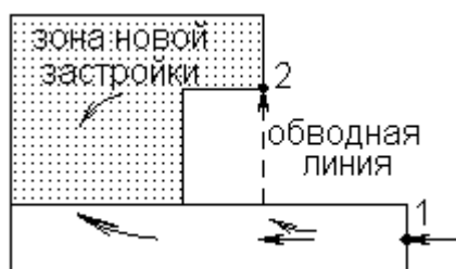
Рис. 3.4. Разгрузка изменением потока распределения
