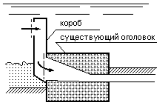
Рис. 2.7. Реконструкция оголовка с целью увеличения высоты порога [1]
