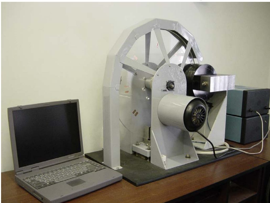
Рисунок 9 - Общий вид коэрцитивного спектрометра J_meter. Результаты отображаются на экране компьютера в виде петель гистерезиса и сохраняются автоматически (рисунок 10).
