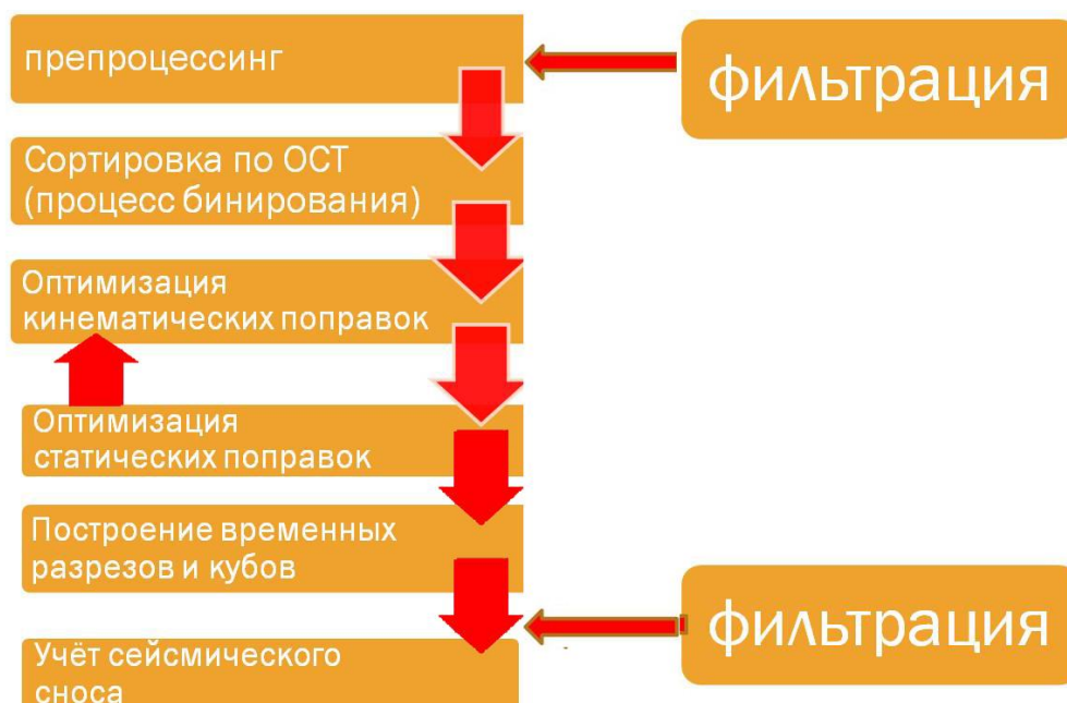
Рис. 2. Блок-схема обобщённого графа цифровой обработки материалов МОГТ
