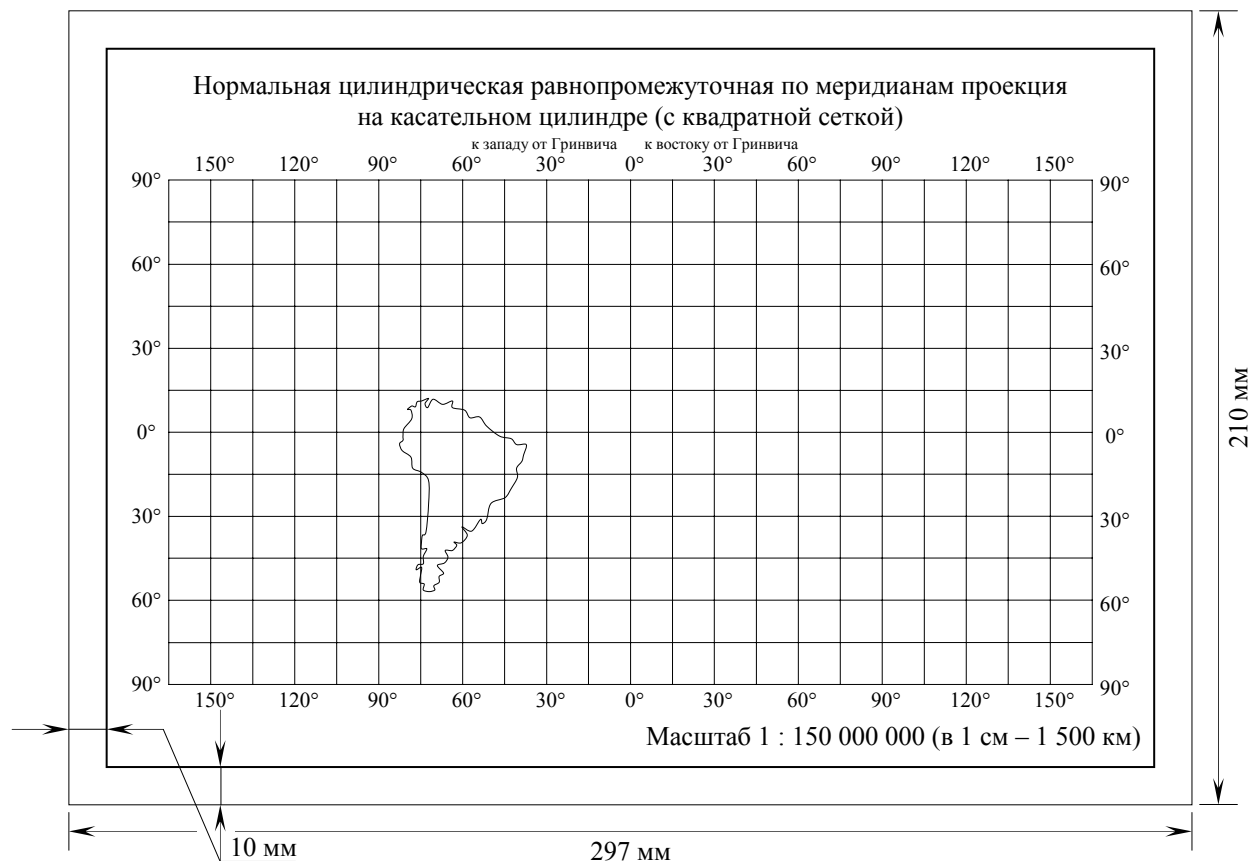
Рис. 31. Макет картографической сетки нормальных цилиндрических проекций с указанием необходимых размеров (уменьшено в два раза).
